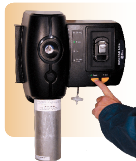
Prueba funcional de ToxiRAE 3 con estación de Calibración y prueba funcional de AutoRAE Lite
